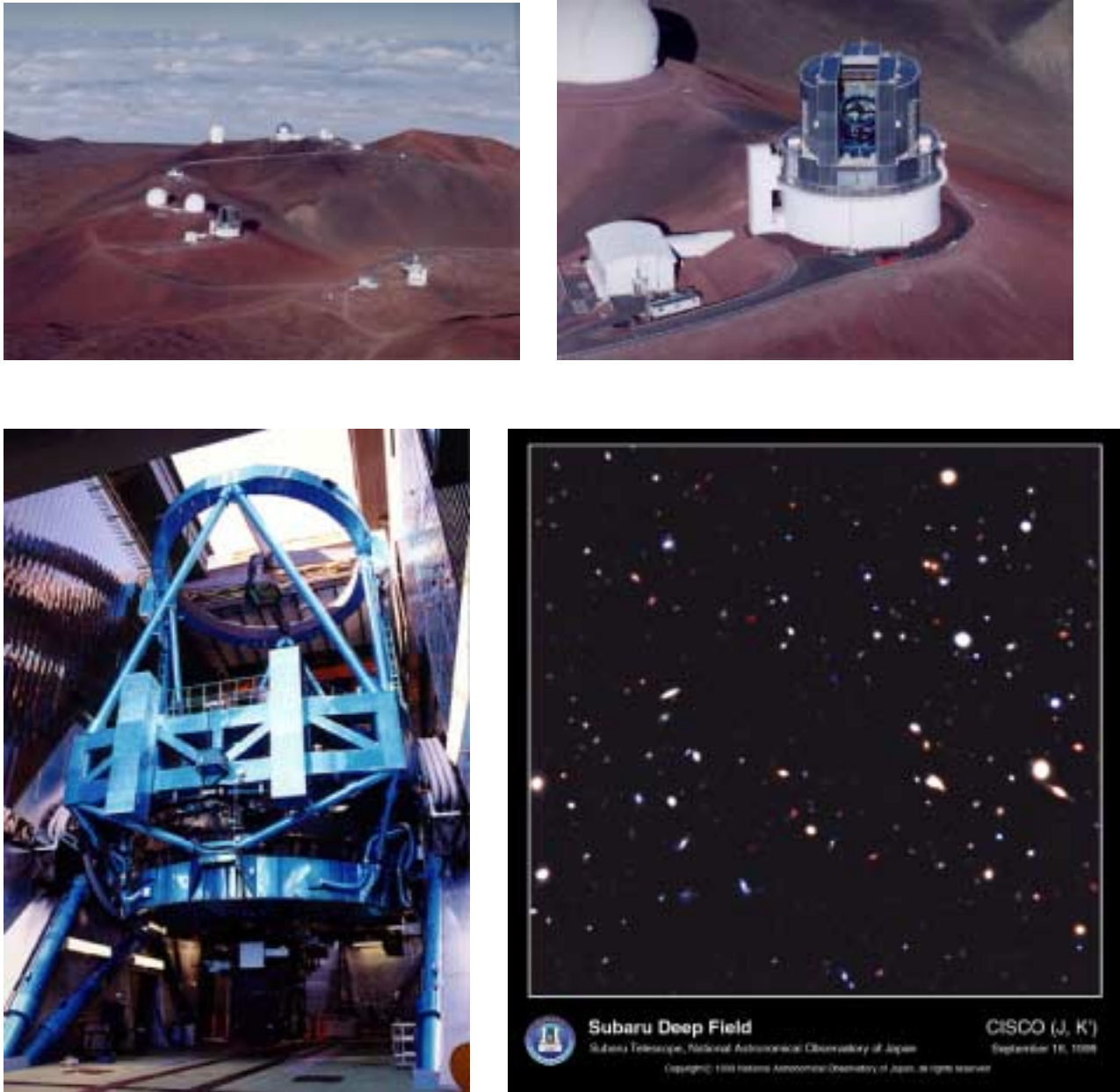
Figure 23: すばる天文台のサイト（左上）、ドーム（右上）、望遠鏡（左下）。右下は、近赤外線カメラ CISCO を用いて、J バンド (1.25 ミクロン) で 12.1 時間、K' バンド (2.13 ミクロン) で 9.7 時間観測して得られた SDF (Subaru Deep Field) 画像。
